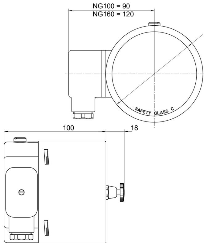
Рис. 12: Корпус с байонетным кольцом и кабельной коробкой
