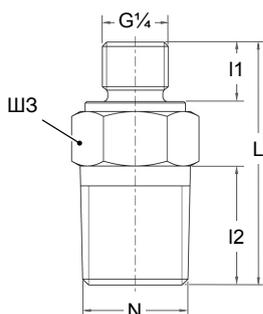
Рис. 9: Соединительная цапфа с резьбой NPT
