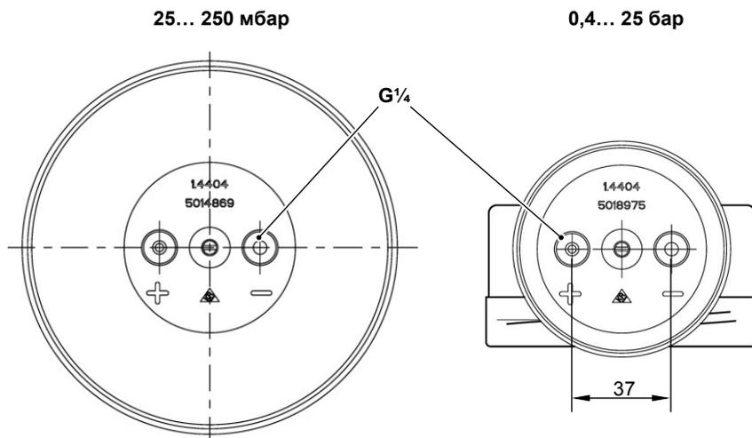
Рис. 7: Техническое подключение
